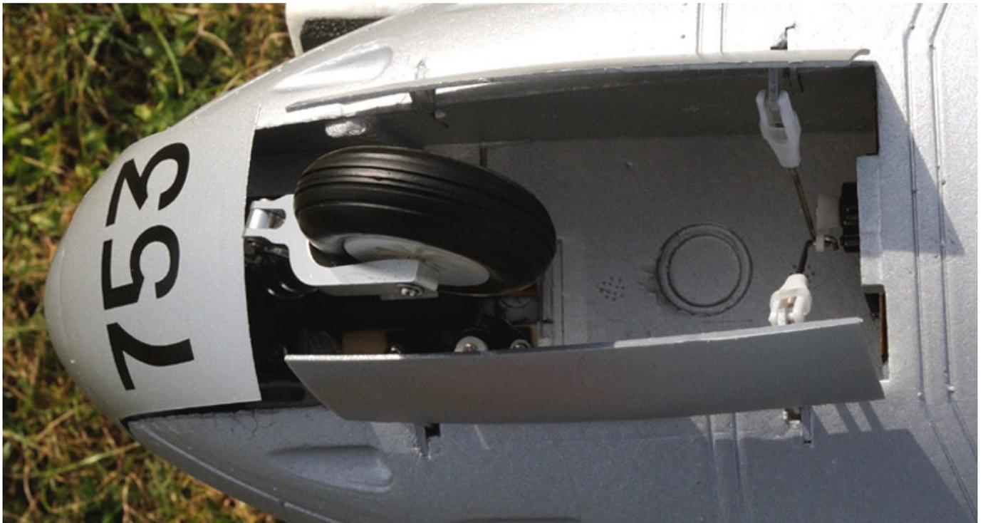
Am Hauptfahrwerk sind auch Abdeckungen angebracht, die mit dem Fahrwerk einziehen. Die Kulissen des Fahrwerks sind aus Kunststoff, die Fahrwerksbeine sind aber komplett aus Metall.
