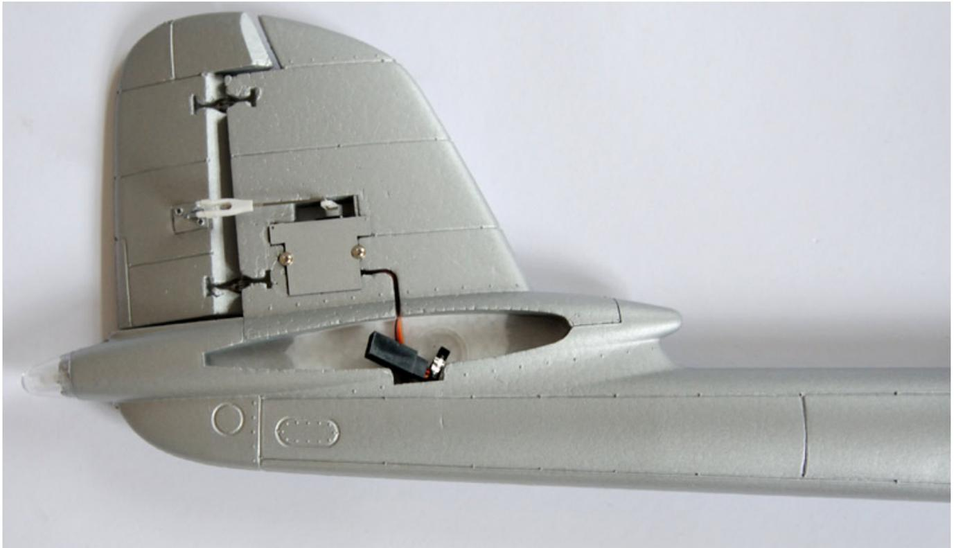
Nun werden die beiden Heckteile mit dem Höhenruder verklebt. Vorher ist das Servokabel mit der Servoverlängerung zu verbinden.
