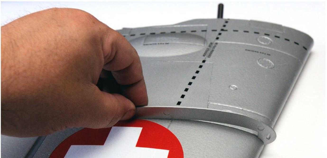
Als nächstes kommt die Hecksektion dran. Als erstes werden die beiden Außenflächen des Höhenleitwerks angeklebt. Wie bei allen Komponenten gibt es hier erfreulicherweise kein Spiel und die Teile passen alle exakt ineinander.
