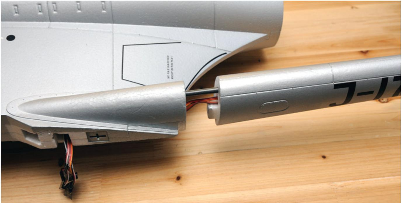
Nach der Fertigstellung des Heckteils ist dieses mit dem Rumpf zu verkleben. In den beiden Heckteilen sind Karbonstäbe eingelassen die aus den Heckteilen heraus schauen. Diese werden in zwei Stahlröhrchen im Rumpf eingeschoben, die Servokabel verbunden, Kleber aufgetragen und dann werden die Heckteile auf den Rumpf aufgeschoben. Zwischendurch kann man noch mal während der Klebezeit die Heckteile auf den Rumpf andrücken um sicherzustellen, dass keine Spalte entstehen.
