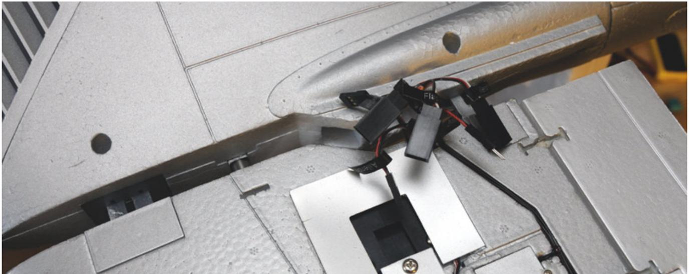
Der Stecker für die Beleuchtung wird auf den Balancer-Stecker des Antriebsakkus gesteckt. Die Stecker für die Beleuchtung sind nicht verpolungsgeschützt. Die beiden LEDs in den Zusatztanks blinken rot und grün als Positionslampen während die weiße LED hinten Dauerlicht abgibt. Die LEDs sind allerdings nicht sehr hell, so dass sie nur am Boden in geringer Entfernung sichtbar sind. Also ein kleiner Zusatz-Gimmick.
