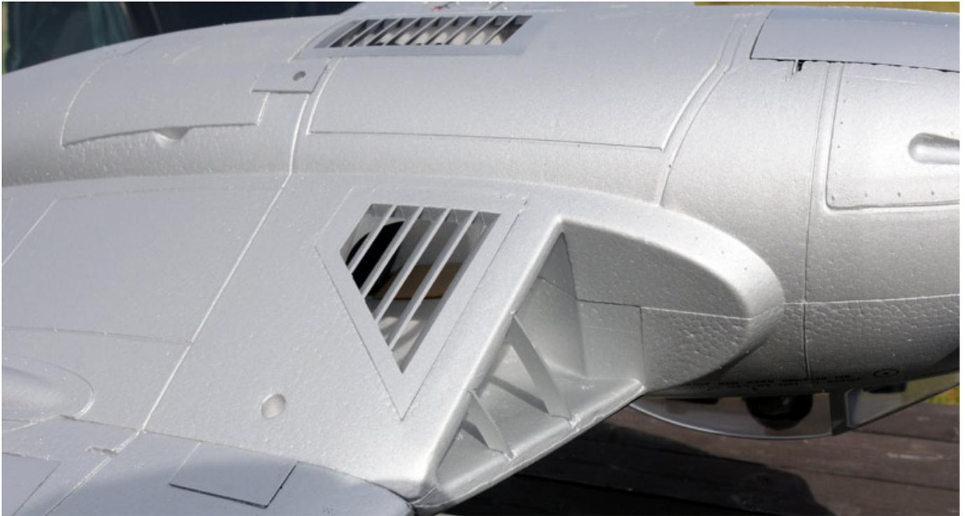
Neben den eigentlichen Einläufen bekommt der Impeller über zusätzliche Öffnungen genügend Luft. Nicht zuletzt durch die Gitter und unterschiedlichen Luftzuführungen bekommt der Jet seinen fauchenden Sound. Der Regler liegt mitten im Luftstrom und kann seine Wärme auch noch über ein zusätzliche Luftöffnung loswerden.
