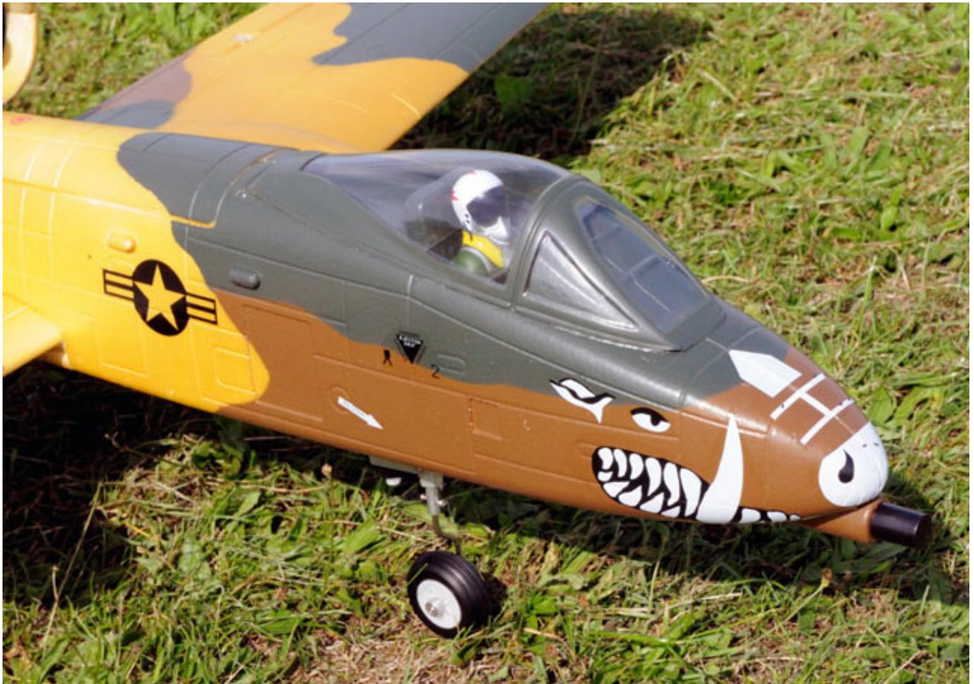
Sämtliche Markierungen sind schon als Wasserschiebebildern aufgebracht. Das Modell selbst ist aus einem widerstandsfähigen Hartschaum.
