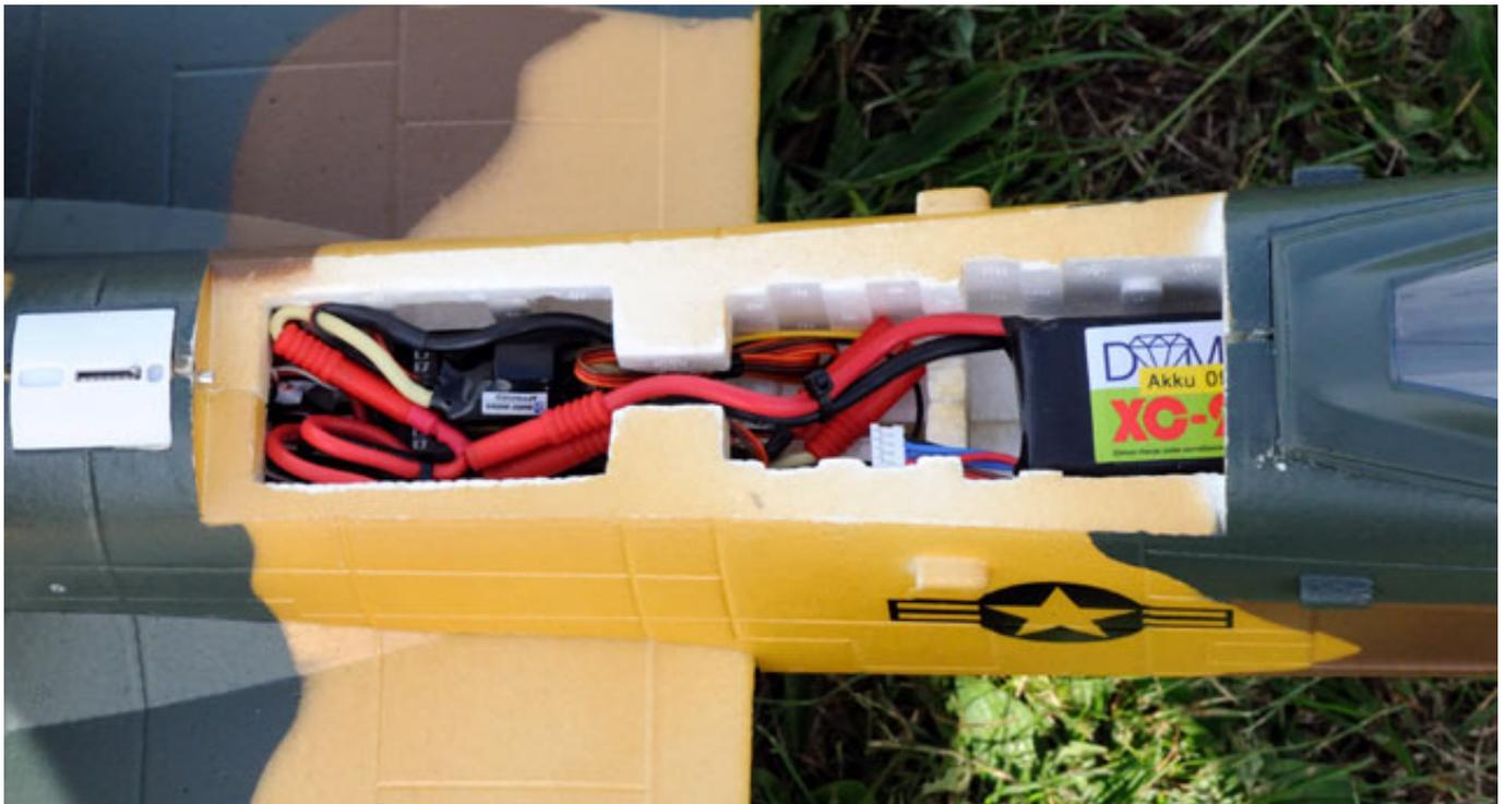
Platz für Empfänger und wie hier ein Strom/Spannungssensor ist genügend vorhanden. Der Diamond XC-2250 Lipo passt perfekt in die Akkuaufnahme und muss nicht extra befestigt werden, da er durch die Abdeckklappe gehalten wird.
