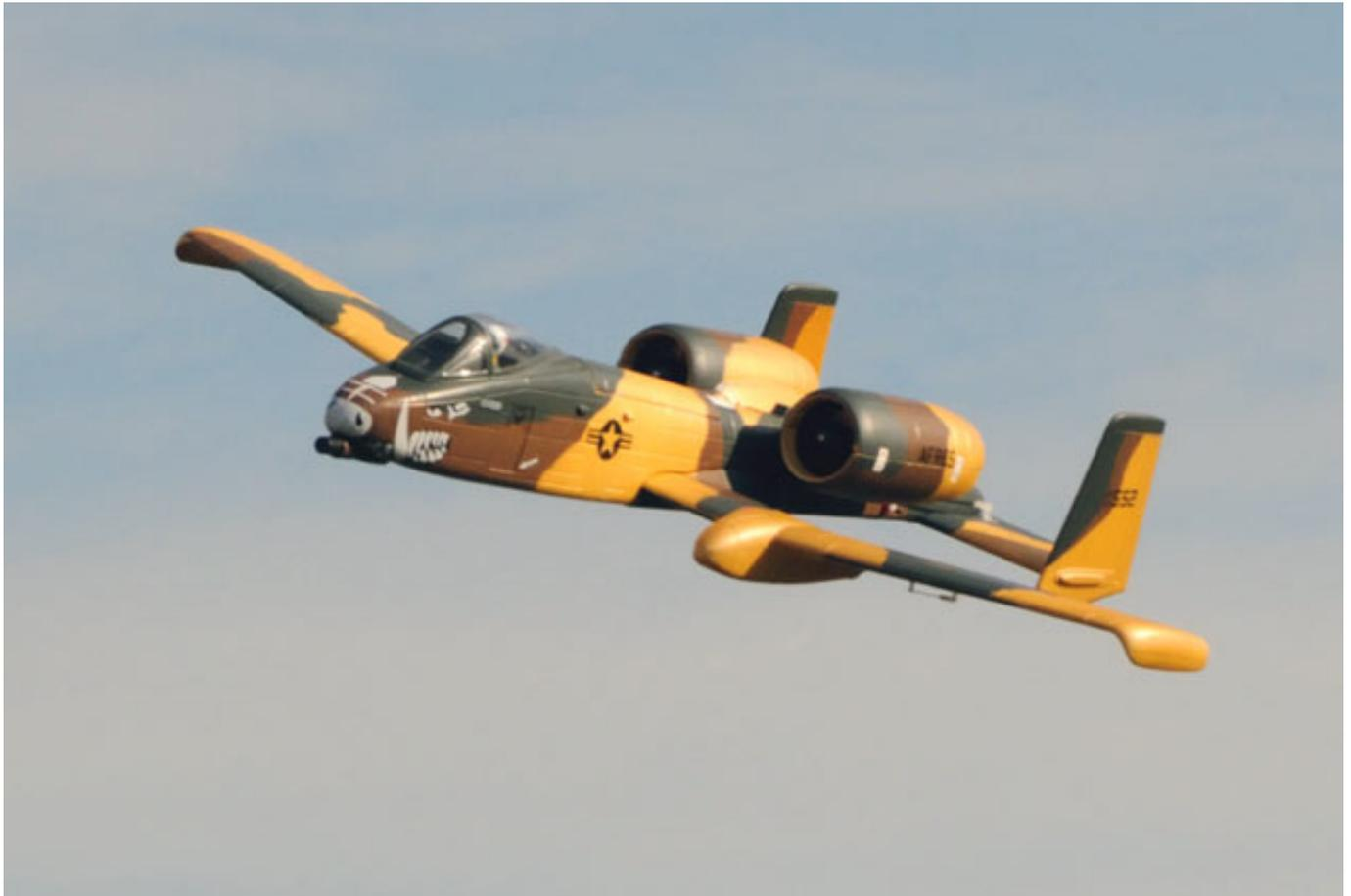
Das Original hat eine sehr hohe Rollrate und wenn vor den Kurven kippt sie sehr schnell in die gewünschte Querlage um am Ende genauso schnell wieder in die Horizontale zurück zu kippen. Dies liegt an den großen Querrudern, die als Spreizruder ausgeführt sind. Wenn man dies simulieren möchte, dann sollte man ggf. eine Akro-Flugphase auf der Fernsteuerung mit 25 % höheren Ausschlägen und mindestens 50 % Expo einrichten, um dies bei Bedarf ansatzweise zu simulieren.
