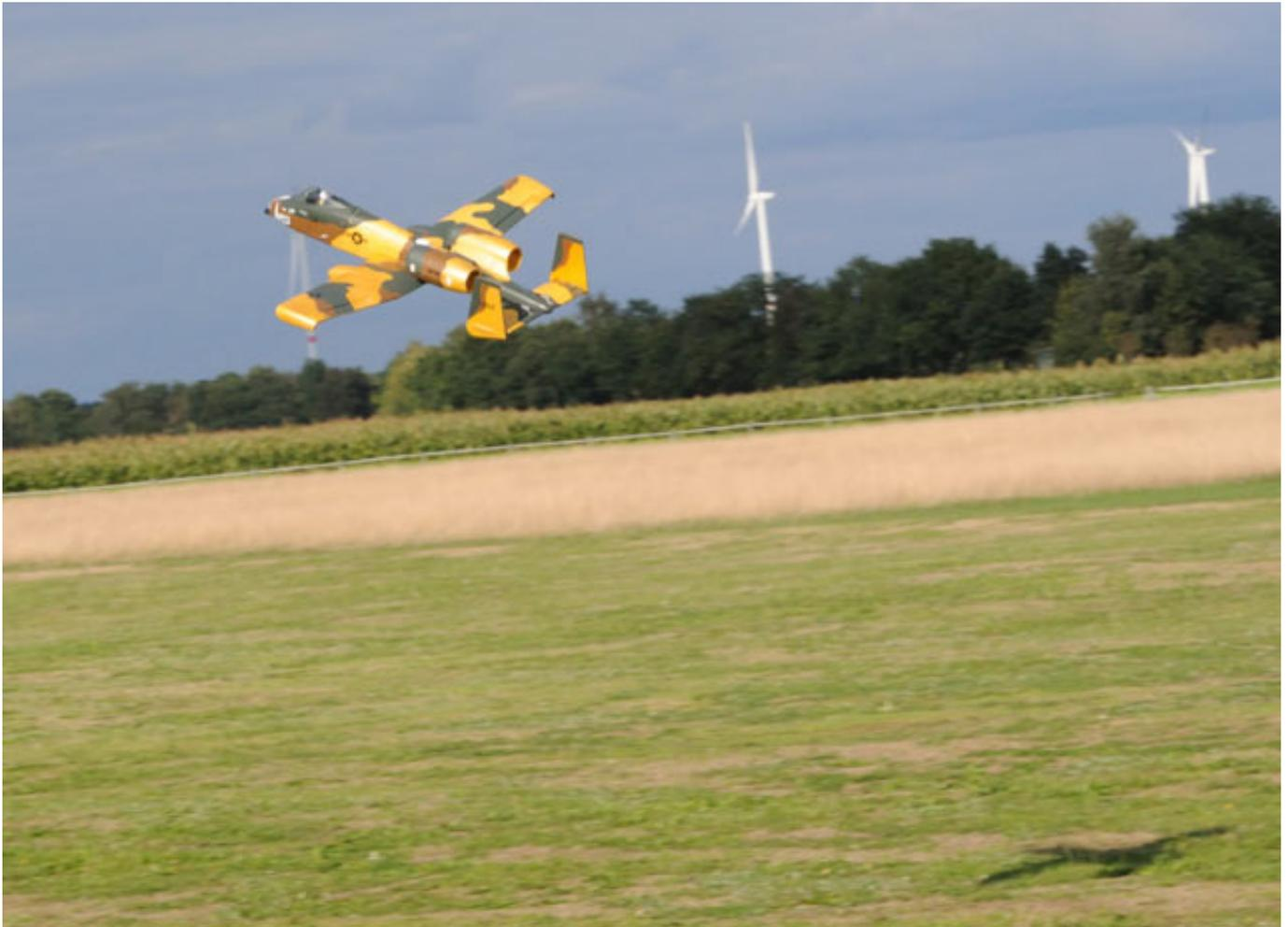
Man sollte zum Handstart eine Startflugphase mit ca. 3 mm Höhenruder programmieren. Mit einem kräftigen Schubs geht es dann kurz nach oben und das Modell fällt dann in die Horizontale und beschleunigt dann zügig. Gegenwind vereinfacht natürlich die Startprozedur.
