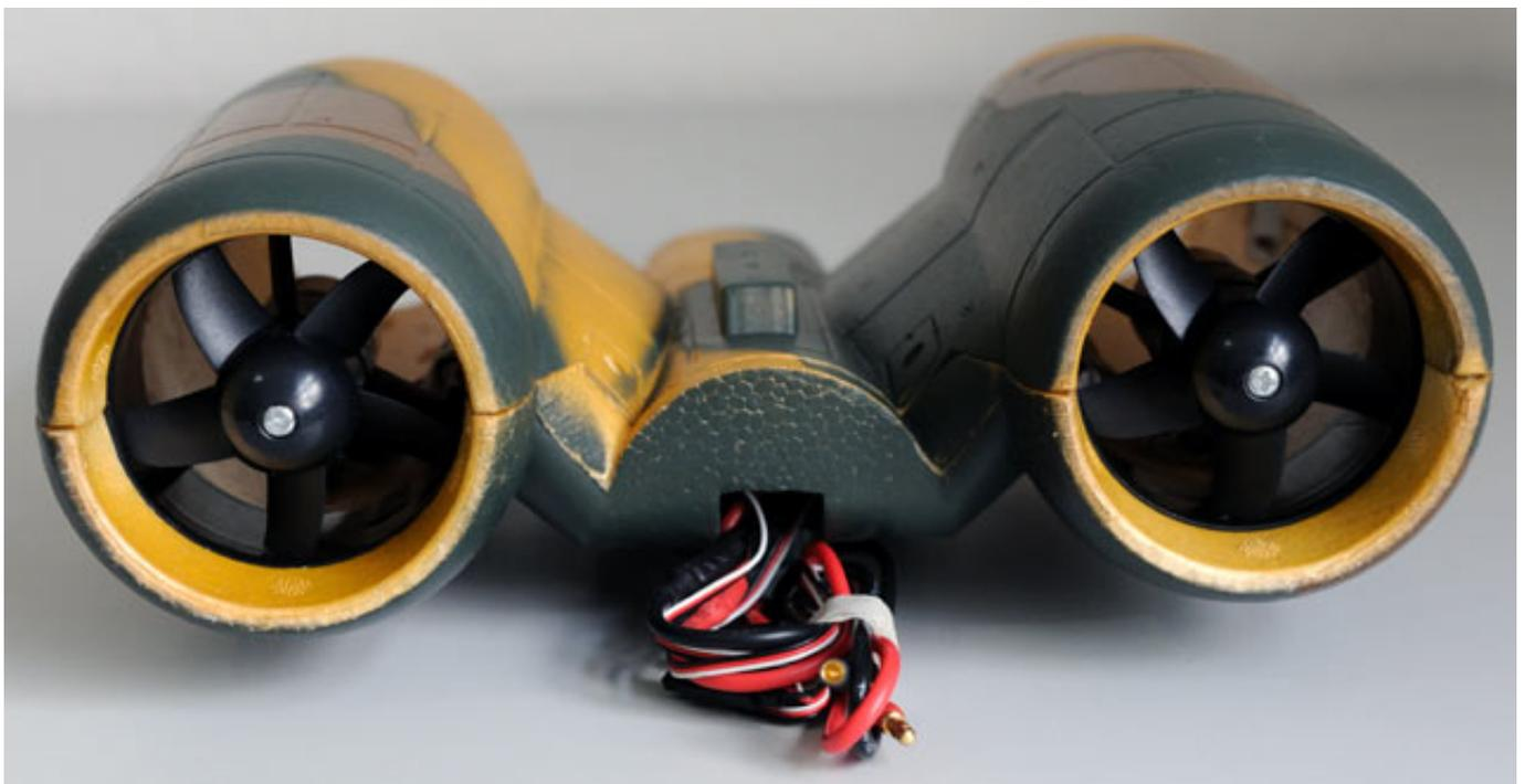
In den Antriebsgondeln sind die beiden 64-mm-Impeller, die beiden Außenläufer und die Regler bereits eingebaut und verdrahtet. Zwar nicht aerodynamisch optimal aber die Regler sind im Luftstrom und so ist sichergestellt, dass sie optimal gekühlt
