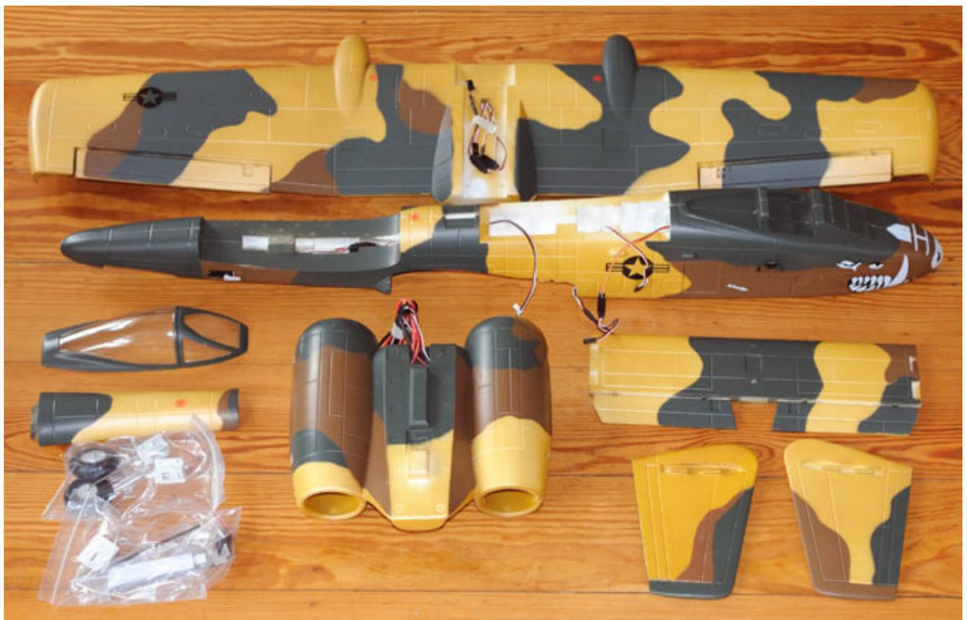
Der Baukasten des ARTF Modells enthält viele vorgefertigte Komponenten, wie den kompletten, nicht geteilten Flügel, das Rumpfsegment, die vorgefertigte Antriebseinheit mit den beiden Triebwerksgondeln, Höhenleitwerk und die beiden Seitenleitwerke, Kabinenhaube, Kanonenattrappe, Kleinteile mit Anlenkungen und Schrauben, sowie die beiden Hauptfahrwerke mit Schrauben. Die Lackierung auf dem Schaum ist sehr gut und robust und blättert bei der Handhabung des Modells auch nicht ab.
