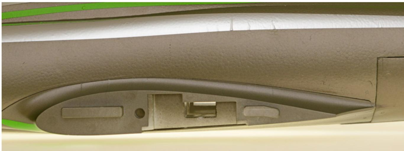
Dann eine Fläche auf die Steckung etwas aufschieben, Multipin-Stecker durch den Rumpf fädeln und dann die Flächenhälfte ganz an den Rumpf drücken und dabei darauf achten, dass das Kabel nicht eingeklemmt wird. Das gleiche nun bei der anderen Flächenhälfte durchführen. Beide Flächenhälften werden nun mit zwei selbstschneidenden Schrauben fixiert.
