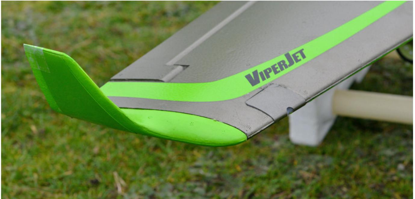
Die Winglets sind außen mit Kunststoff verstärkt aber nicht umschließend. Um zu verhindern, dass die Ecken beim Transport beschädigt werden, sollte man einen Streifen Tesafilm über die Kante kleben (s. Abb. oben). Die Viper ist auch mit zwei nach vorne gerichteten LED-Positionslichtern (Grün/Rot) ausgestattet. Wenn keine Sonne da ist, sind die LEDs auch in der Luft bei der Landung gut sichtbar,
