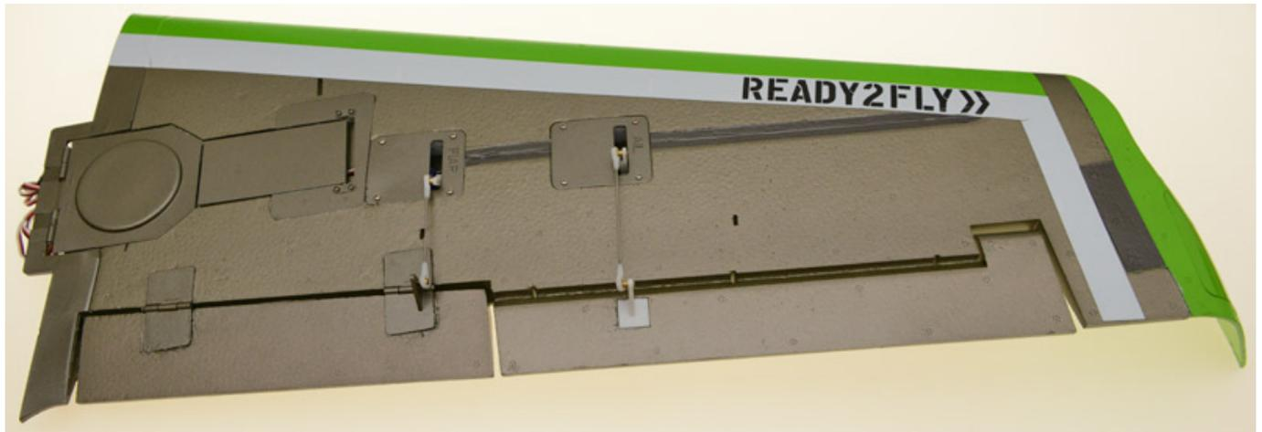
Die gesamten Kabel einer Flügelhälfte laufen auf einen Multipin-Stecker auf (s. Abb. unten). An dem Kabel befindet sich auch das Modul für die Kontrolle des Fahrwerks und der verzögerten Fahrwerksklappen.
