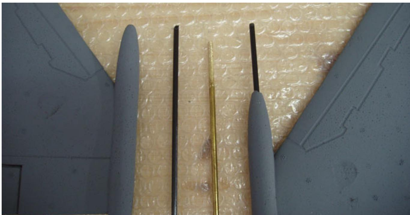
Abhilfe schafft hier ein 6-mm-CFK-Rohr, das komplett durch den Strömungskörper geführt wird. Das Loch dazu macht man ebenfalls mit einem angespitzten Messingrohr. Man sollte das Rohr so lang machen, dass es gerade mit dem
