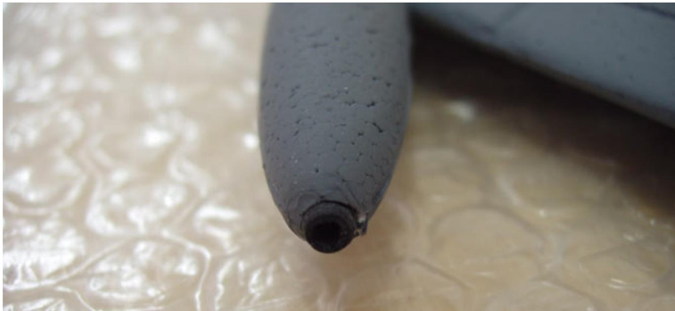
Das Loch des Kohlerohr verschließt man dann auf beiden Seiten und mit etwas Farbe (Revell Aqua Color Mittelgrau 361 43) wird die Modifikation dann getarnt.
