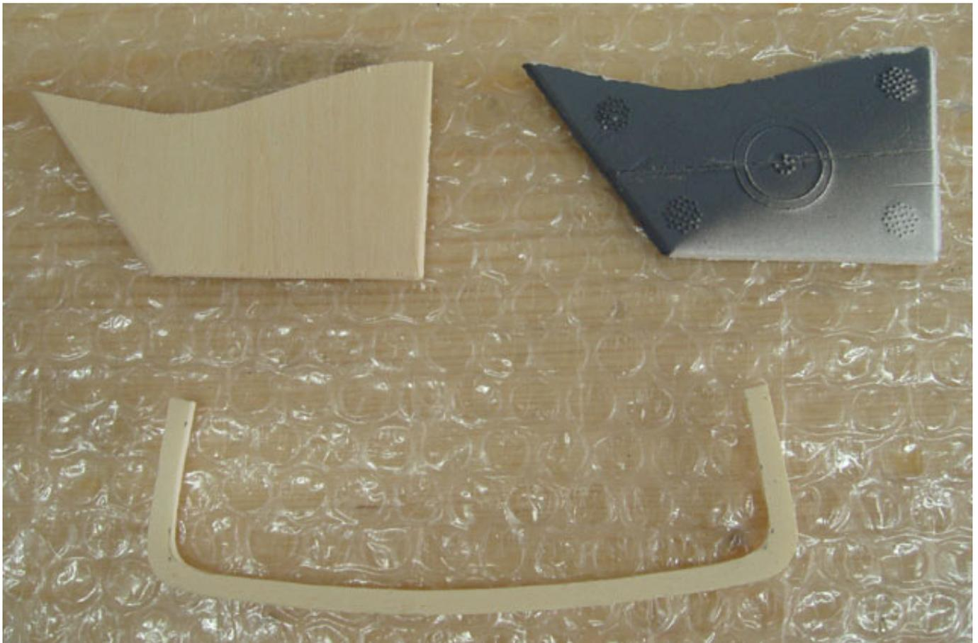
Der Lufteinlauf wurde rundherum mit einem Holzteil verstärkt und das Mittelteil ebenfalls durch ein Holzteil ersetzt. Hierzu trennt man das Styroteil aus dem Einlauf heraus und formt es nach (siehe oben).
